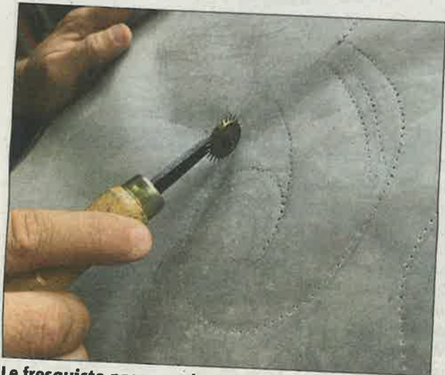
Le fresquiste passe sur le dessin avec une roulette à patron. Les petits trous vont permettre de l'utiliser comme pochoir pour reproduire le motif plusieurs fois.
